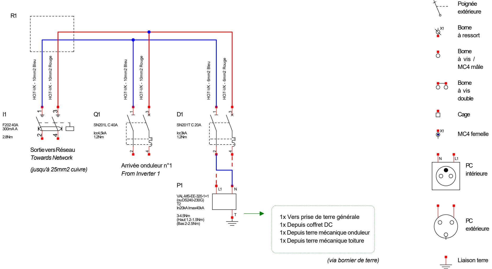
I : Interrupteur-sectionneur - AC or DC Switch ou/or Interrupteur-différentiel - Residual Current Circuit Breaker
