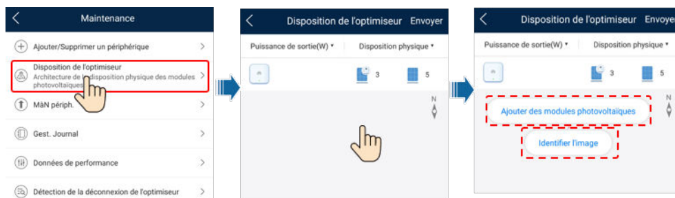
Figure 7-7 Disposition physique des modules PV
