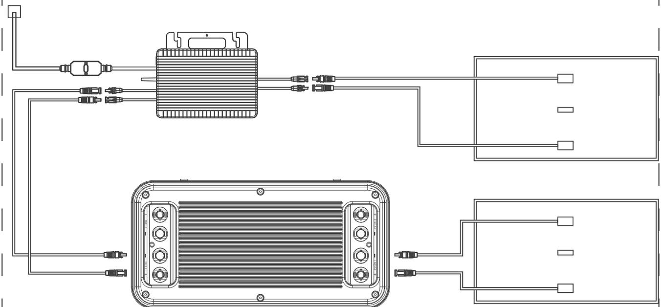
\*Dieser Betriebsstörung kann der Umstand zugrunde liegen, dass sich im Inneren einiger der auf dem Markt erhältlichen Mikro-Wechselrichter ein Schutzleiter befindet. Sind die beiden Mikro-Wechselrichter-Kanäle gleichzeitig an ein Akkupack angeschlossen, funktioniert der Mikrowechselrichter nicht ordnungsgemäß.
