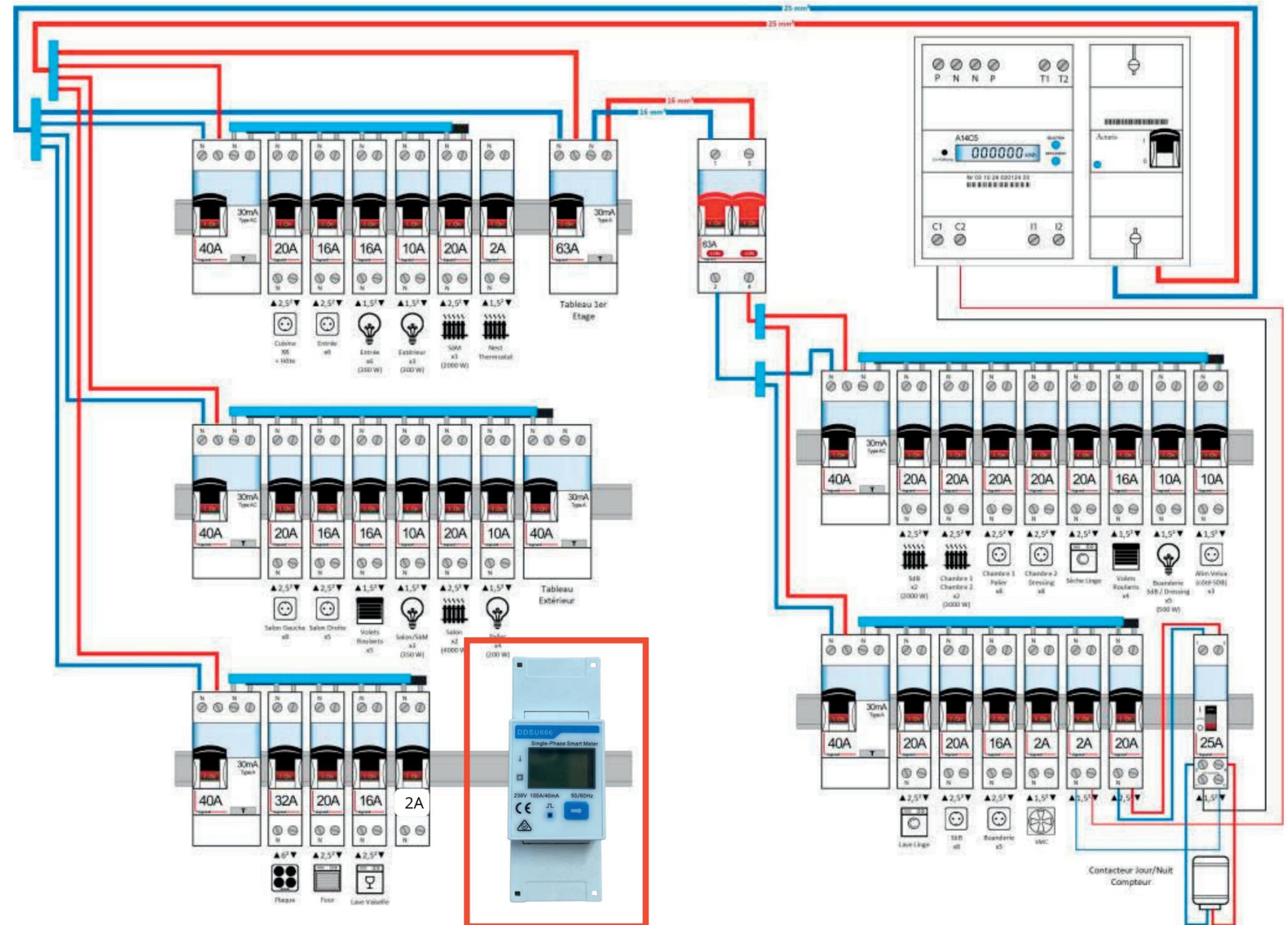
Raccordez le tore de mesure et le DTU PRO au DDSU 666
